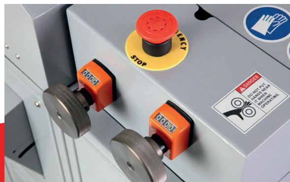
Instelknoppen voor de afstand tussen de coatingrollen voor eenmalige aanpassingen
