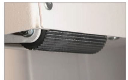
Verbeterd PGO-opruwstelsel voor rug-preparatie, speciaal voor moeilijk, dik en gecoat papiersoorten
