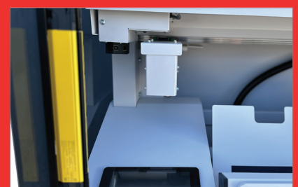
Lichtlijnbeveiliging ter bescherming van de gebruiker
