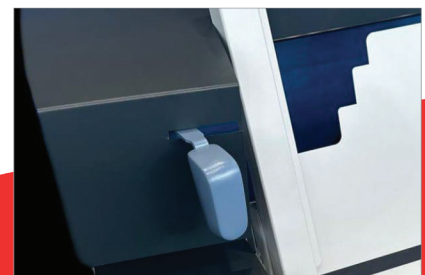
Optioneel PGO Gen 5 opruwsysteem: Rugpreparatie voor moeilijke papersoorten.
